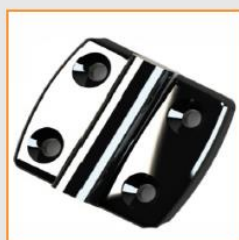
Dobradiça injetada em Poliamida com Fibra de Vidro com pino em aço 1020 Acabamento preto.
